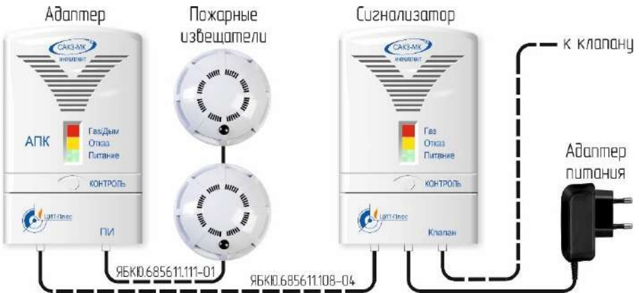
Рисунок В.2 – Типовая схема включения с пожарными извещателями
